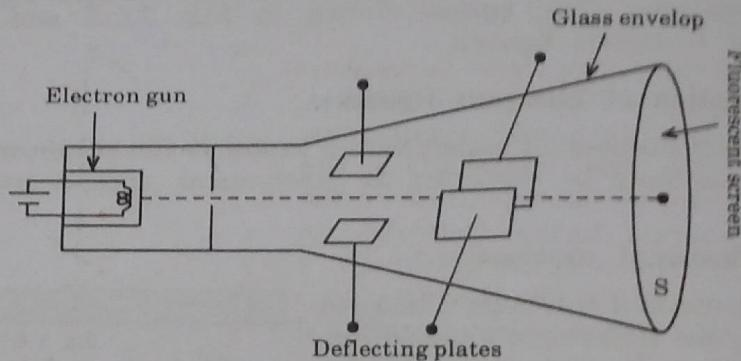
Fig. 2.6-3 : Cathod-ray oscilloscope
