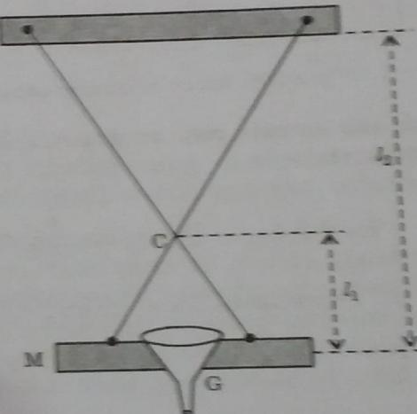
Fig. 2.6-1 : Blackburn's pendulum
